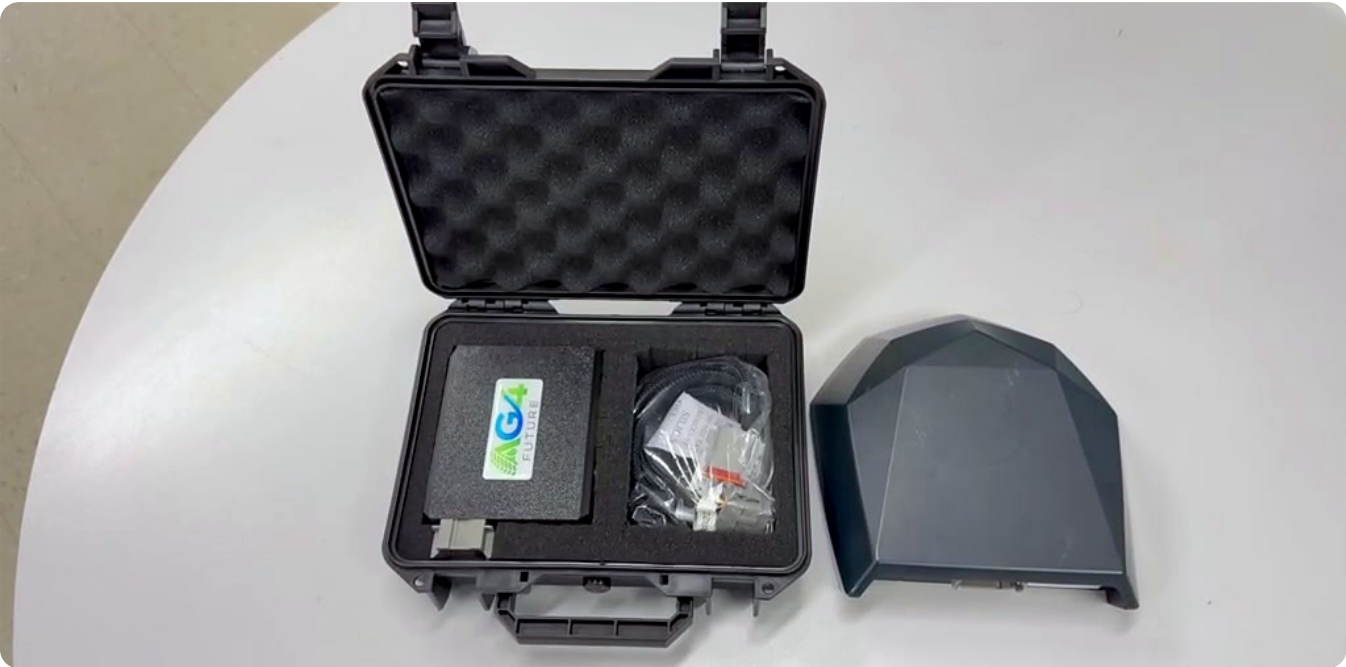
Maleta aberta. Módulo Mapper no compartimento superior, chicote da antena embalado no compartimento inferior e, ao lado, a antena GNSS Nordion.
