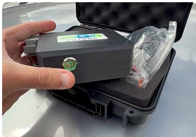
Botão liga/desliga. Botão metálico com anel luminoso verde quando o módulo está ligado.
