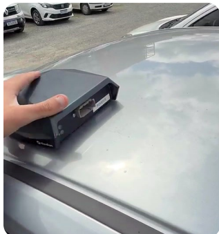
1. Antena GNSS no teto do veículo
