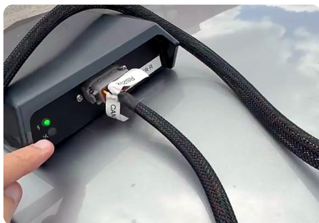
Conector e LED de status. Conector automotivo do chicote da antena e LED verde de operação na mesma face.
